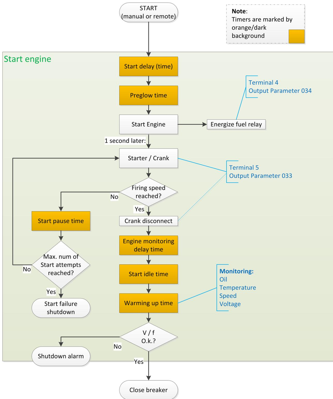
Fig. 3 : Procédure de démarrage du moteur
