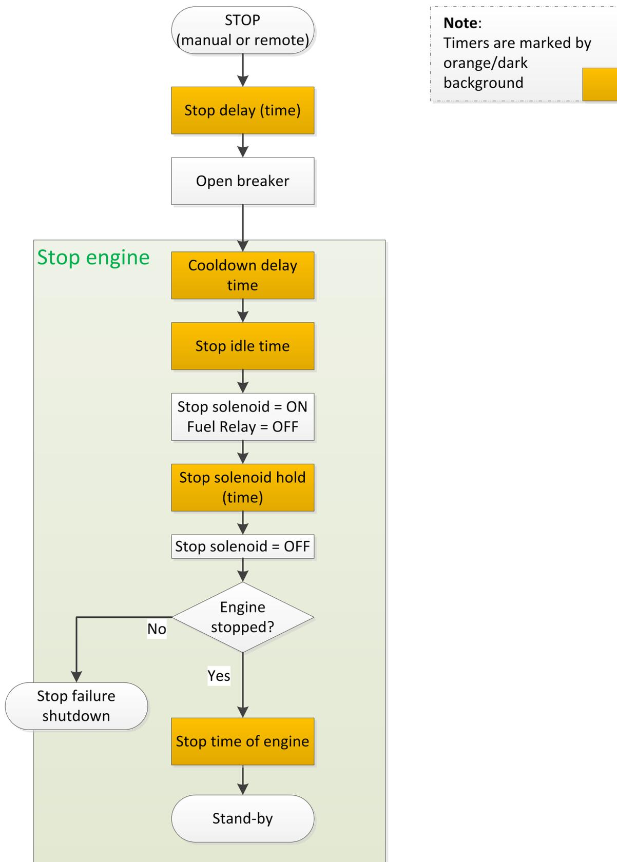
Fig. 4 : Procédure d'arrêt/mise en attente du moteur
