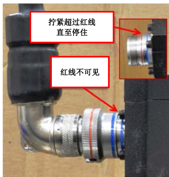
图 3-2. 电动机分解器连接器
