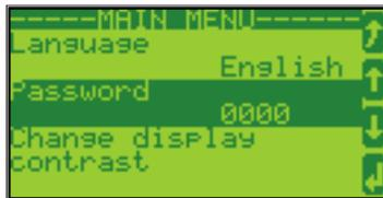
Das Navigieren zwischen den verschiedenen Parametern erfolgt mittels der Softkeys und . Um den ausgewählten Parameter zu bearbeiten, drücken Sie . Um Ihre Änderungen zu speichern, drücken Sie . Drücken Sie , um die Parametrierung ohne Übernahme der Änderungen zu verlassen.
