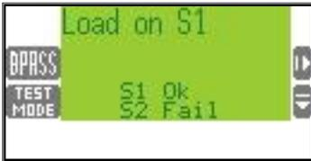
Im Normalbetrieb werden der aktuelle Betriebszustand des Geräts sowie der Zustand der Quellen angezeigt.
