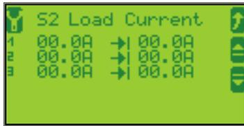
Dieser Bildschirm erscheint nach nochmaligem Drücken des Softkeys . Die Schleppzeiger zeigen die vom Steuergerät überwachten Maximalströme an.
