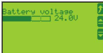
Dieser Bildschirm erscheint nach nochmaligem Drücken des Softkeys . Die gemessene Batteriespannung wird grafisch und numerisch angezeigt.
