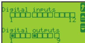
Dieser Bildschirm erscheint nach nochmaligem Drücken des Softkeys . Die Zustände der Digitaleingänge und der Digitalausgänge werden angezeigt.
