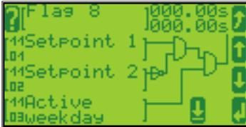
Zur Konfiguration des *LogicsManager* werden die Softkeys auf der rechten und unteren Bildschirmseite verwendet. Der Softkey auf der linken Seite öffnet einen Hilfe-Bildschirm. Die Softkeys sind mit unterschiedlichen Funktionen belegt.
