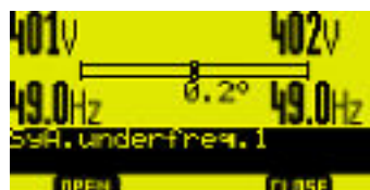
Abb. 128: LS-5x2 v2-Synchronoskop in Betriebsart HAND (Beispiel)
