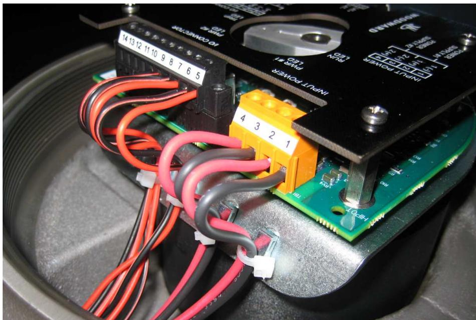
Figura 3-6. Liberación de tensión del cableado recomendada
