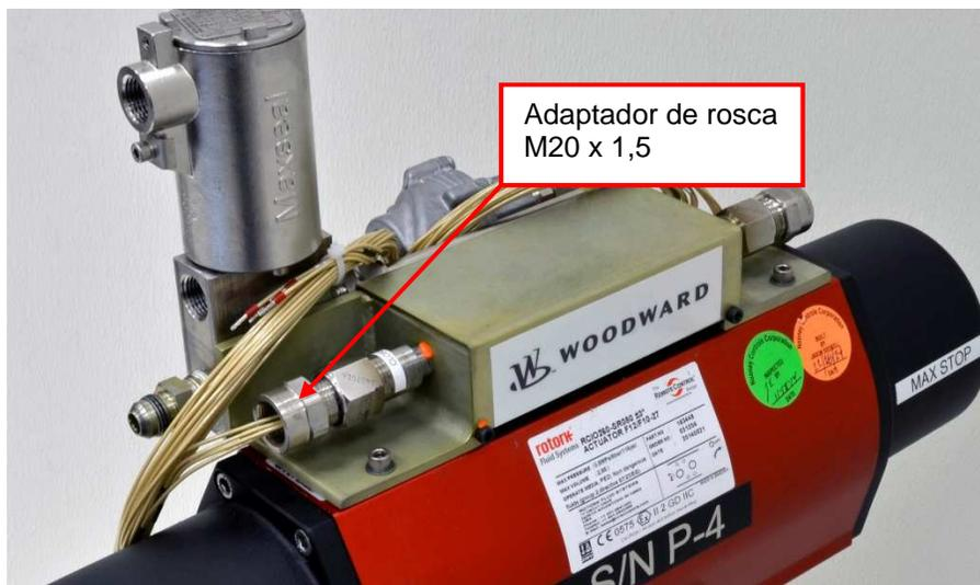
Figura 2-14. Adaptador de rosca para el interruptor de proximidad
