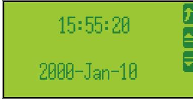
Dieser Bildschirm informiert über die aktuelle Uhrzeit sowie das aktuelle Datum. Die Uhr ist als Echtzeituhr ausgeführt. Bei einem Spannungsausfall (Versorgungsspannung) stellt eine interne Batterie sicher, dass die Informationen nicht verloren gehen. Die Daten bedeuten:
