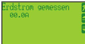
Falls der Stromwandlereingang auf Erdstrom parametriert ist, erscheint dieser Bildschirm nach nochmaligem Drücken des Softkeys
