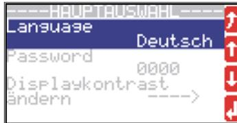
Das Navigieren zwischen den verschiedenen Parametern erfolgt mittels der Softkeys und . Haben Sie den Parameter gefunden, den Sie ändern wollen, wählen Sie diesen über aus und ändern ihn entsprechend ab. Der Parameter wird mittels gespeichert. Drücken Sie , um die Parametrierung ohne Änderungsübernahme zu verlassen.
