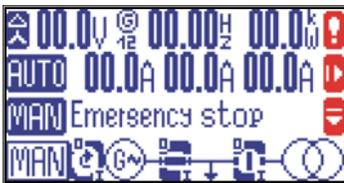
Zur Navigation zwischen den Hauptbildschirmen werden die Softkeys auf der rechten Bildschirmseite verwendet. Die Softkeys werden in Abhängigkeit des aktiven Bildschirms mit unterschiedliche Funktionen belegt.
