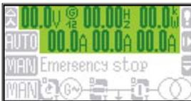
Die "Messwerte"-Ebene zeigt alle Messwerte inkl. Spannungen, Frequenzen und Leistungen an.
