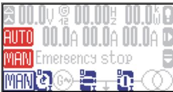
Durch das Drücken der Softkeys **AUTO**, **MAN** oder **STOP** wird die Betriebsart ausgewählt. Entsprechend der ausgewählten Betriebsart werden auf dem Bildschirm unterschiedliche Softkeys aktiviert und deaktiviert. Weiterhin wird im Motor-Symbol die ausgewählte Betriebsart angezeigt. Wurde die Betriebsart STOP gewählt, leuchtet die LED rechts neben dem Taster auf.
