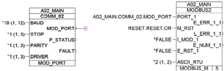
図 8-2. MODBUS\_M ブロックの例
