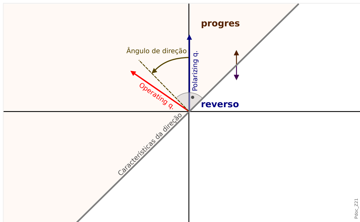
Fig. 64: Princípio de detecção da direção de falhas de fase
