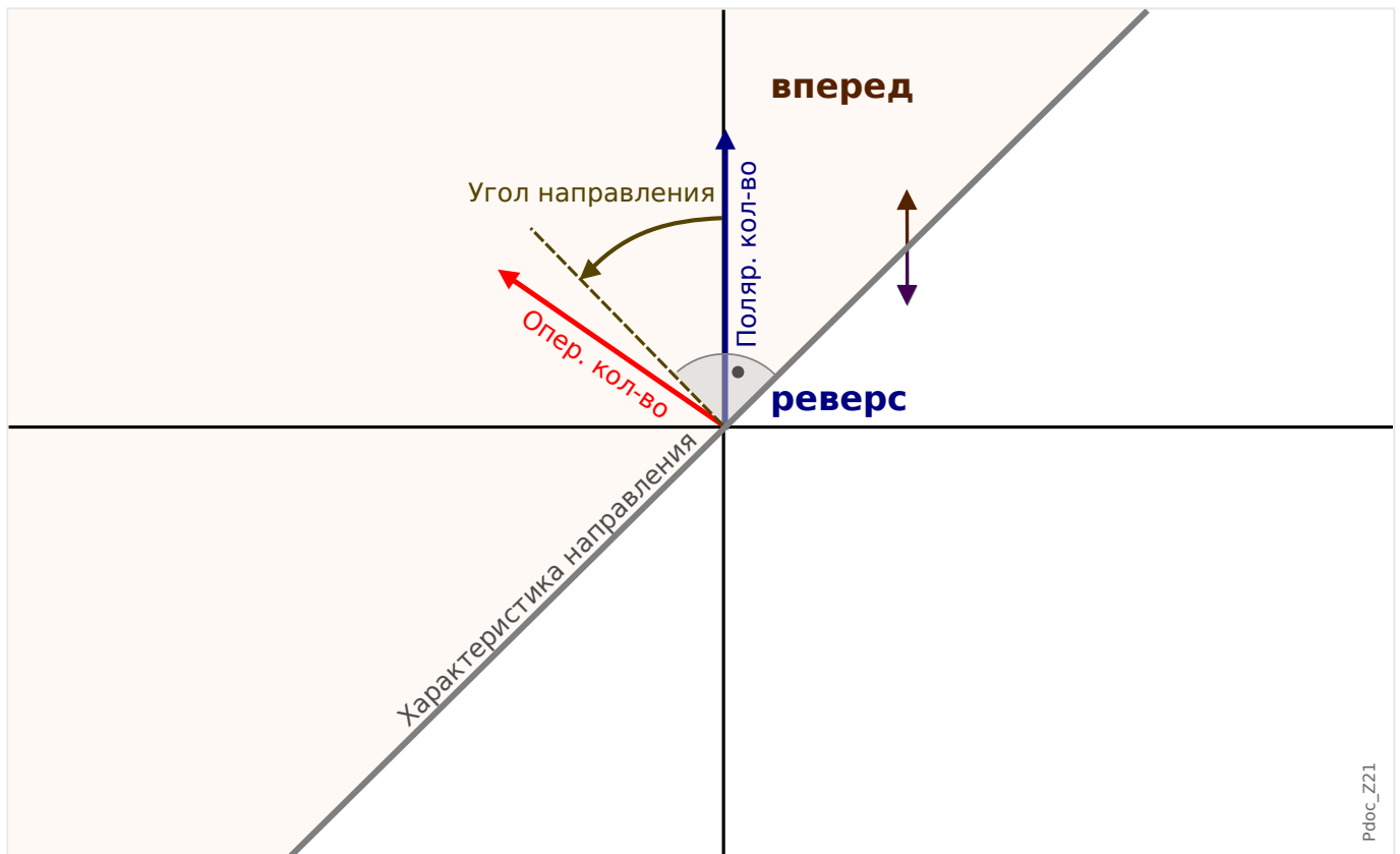
Рис. 64: Принцип определения направления межфазного короткого замыкания.
