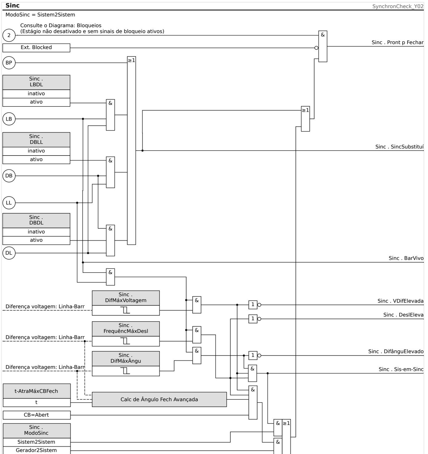
Fig. 112: Funcionalidade do módulo »Sinc«, "Sistem2Sistem".
