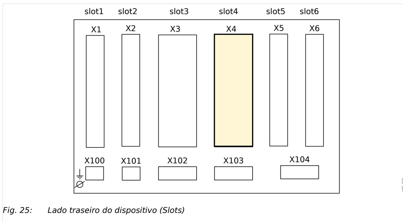
Fig. 25: Lado traseiro do dispositivo (Slots)
