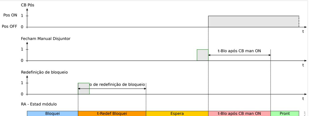
Fig. 107: A lógica de reinicialização de travamento no caso do reinício do travamento vir antes do fechamento manual do disjuntor
