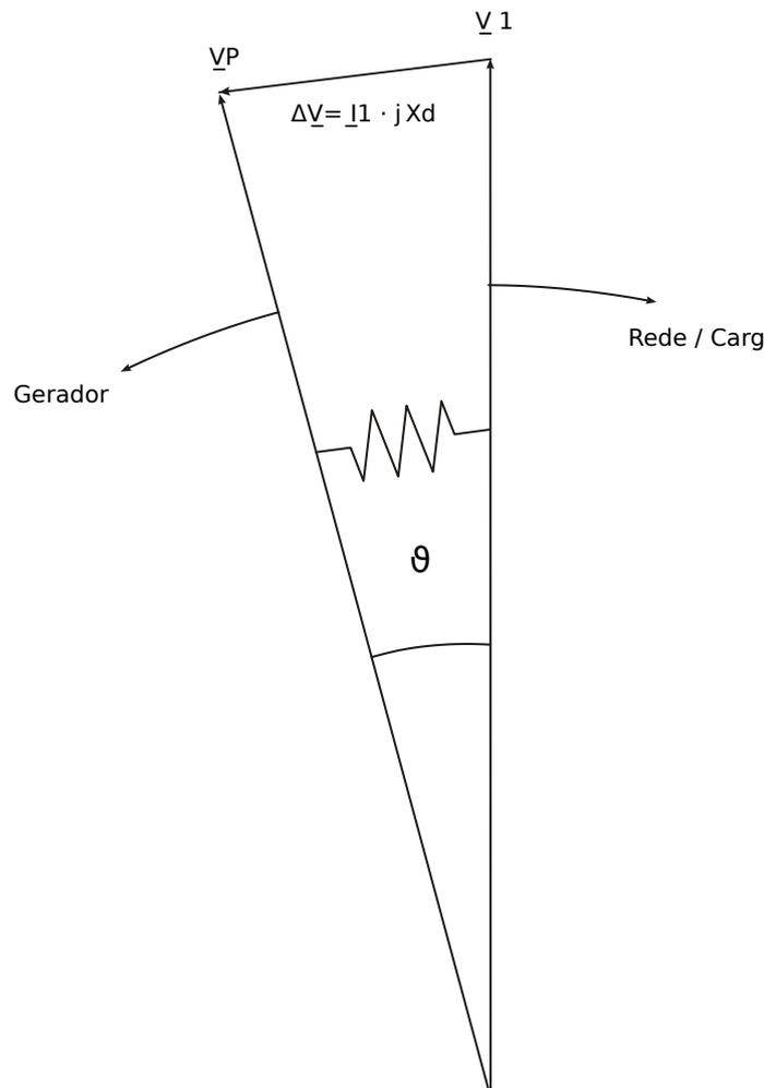
Fig. 85: Vetores de voltagem em operação paralela.
