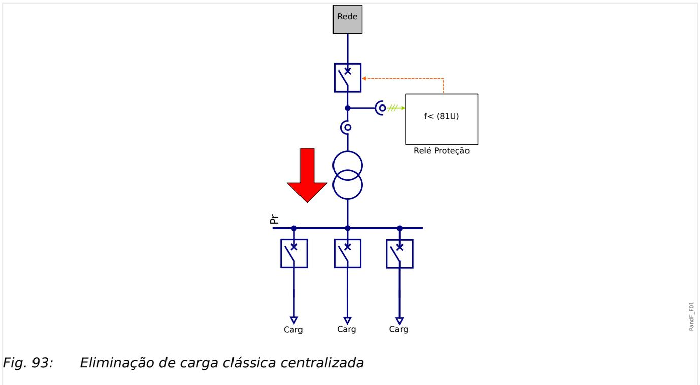
Fig. 93: *Eliminação de carga clássica centralizada*
