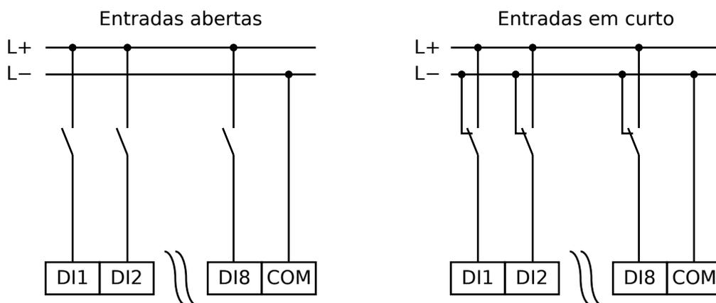
Fig. 140: Estado seguro das entradas digitais
