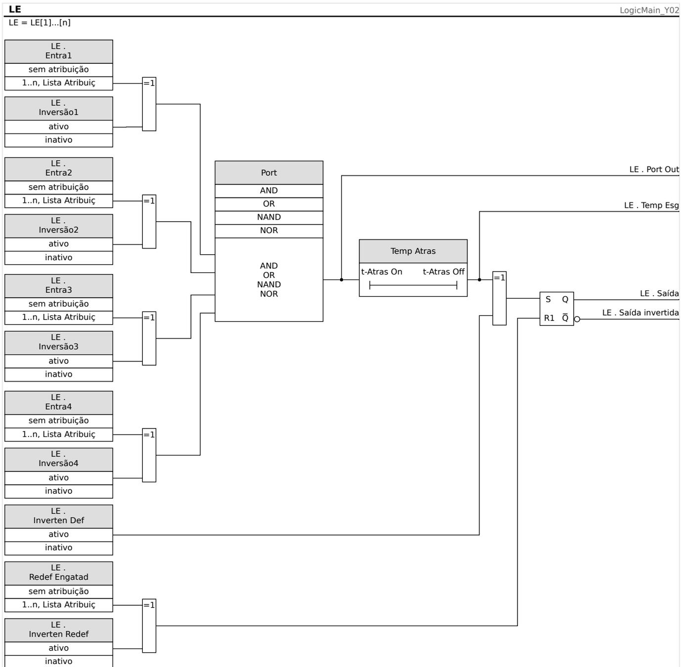
Fig. 131: Visão Geral Detalhada - Diagrama Lógico Geral.
