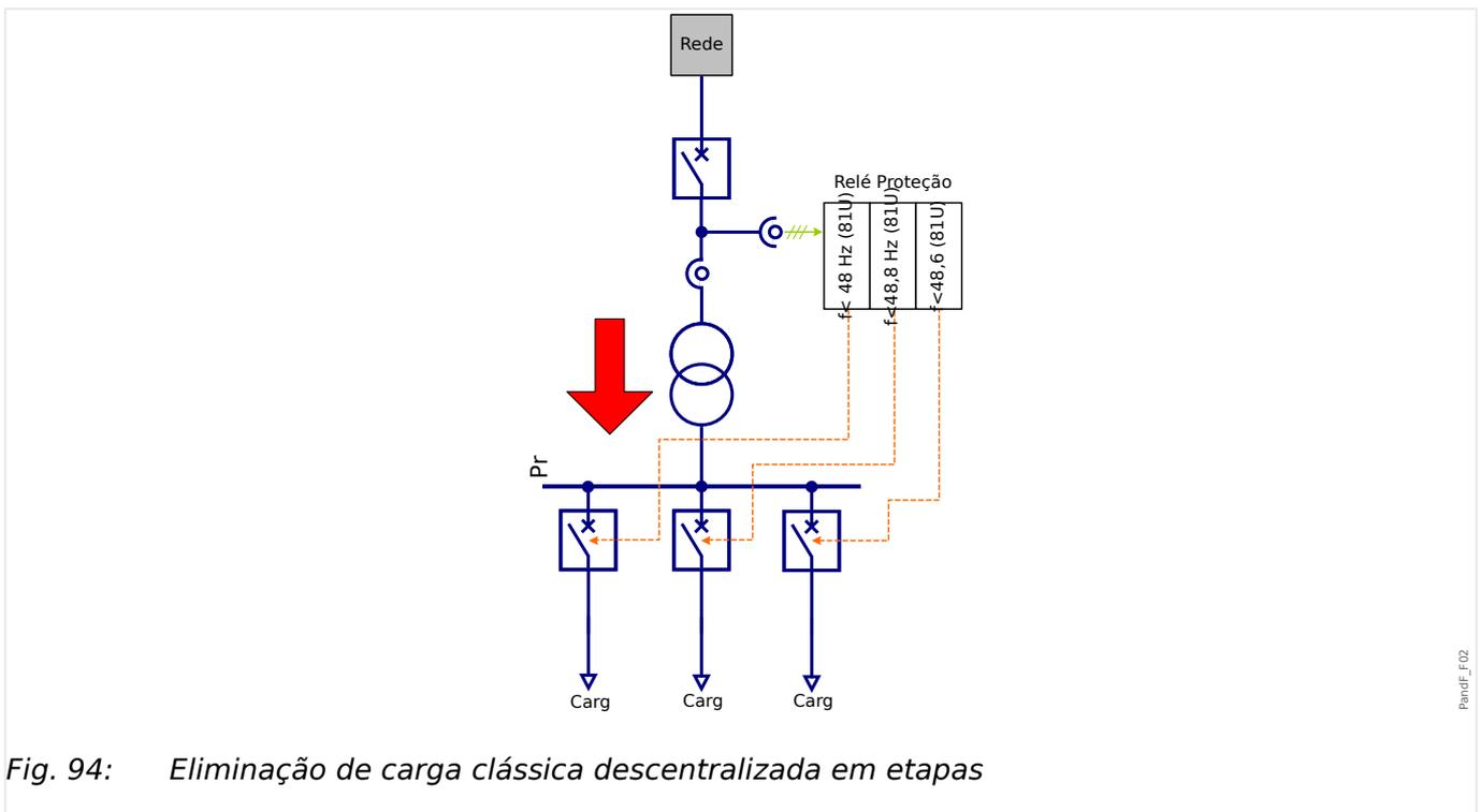
Fig. 94: *Eliminação de carga clássica descentralizada em etapas*
