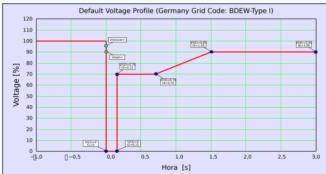
Fig. 80: Perfil padrão do LVRT (BDEW-Tipo I).
