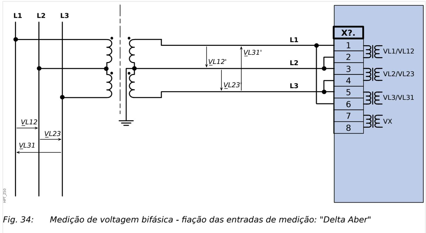
Fig. 34: Medição de voltagem bifásica - fiação das entradas de medição: "Delta Aber"
