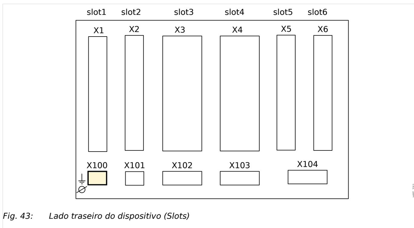
Fig. 43: Lado traseiro do dispositivo (Slots)
