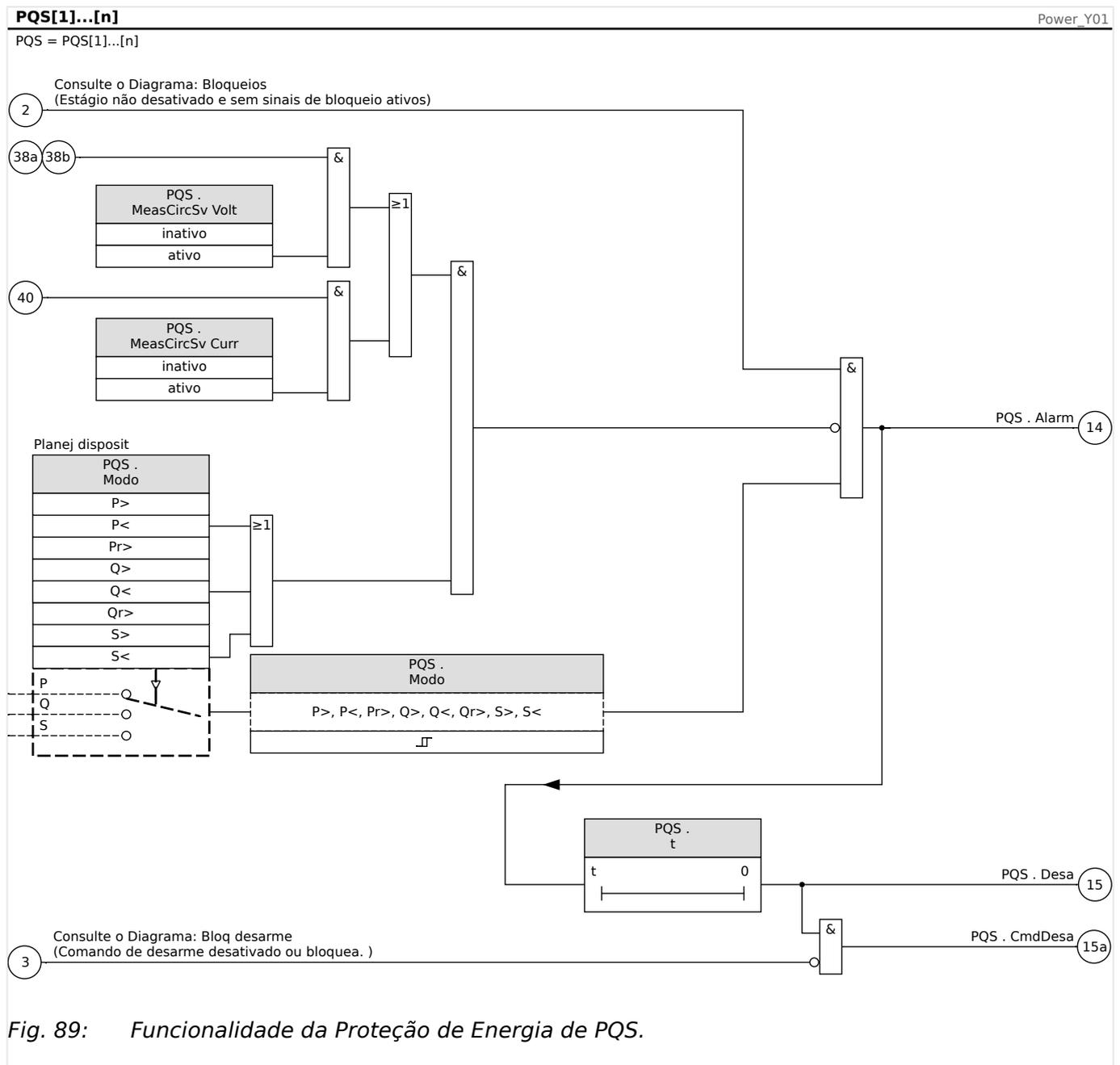
Fig. 89: Funcionalidade da Proteção de Energia de PQS.
