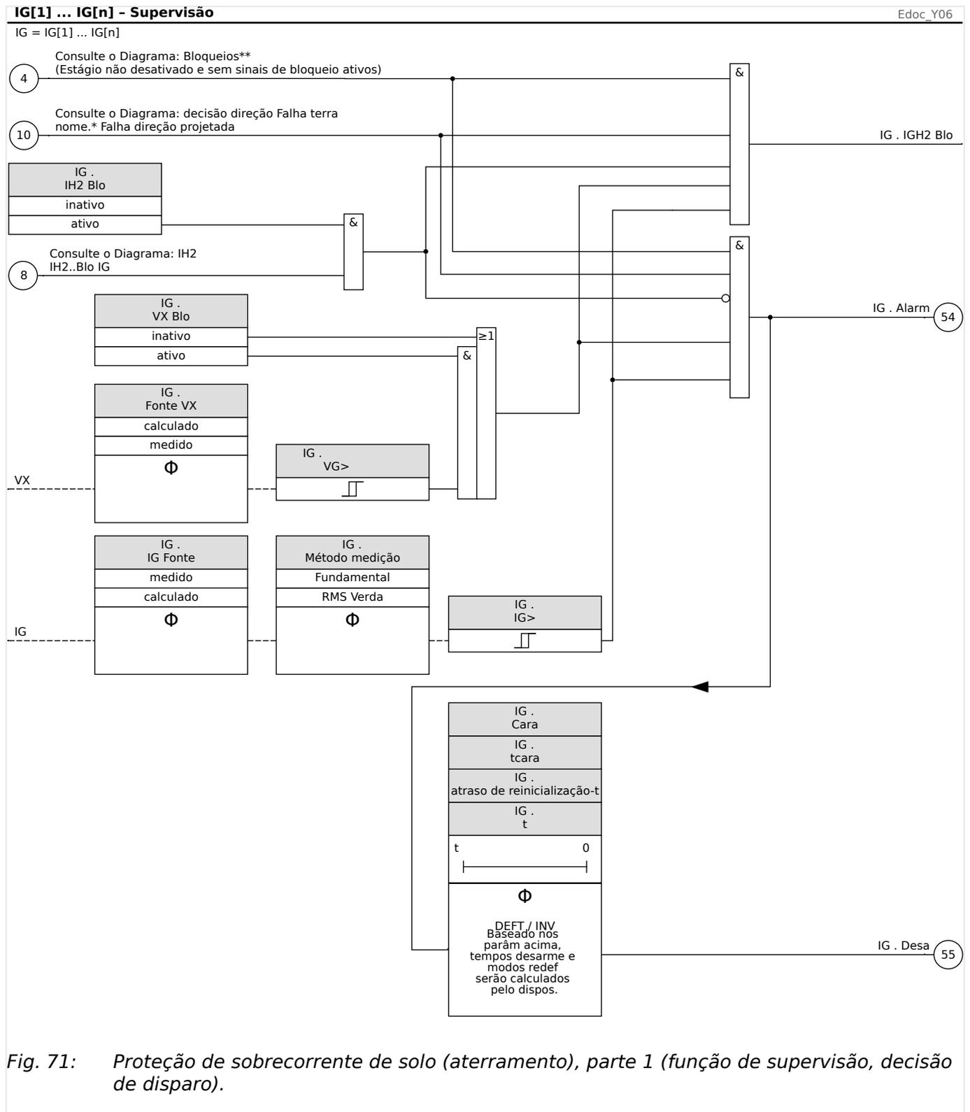
Fig. 71: Proteção de sobrecorrente de solo (aterramento), parte 1 (função de supervisão, decisão de disparo).
