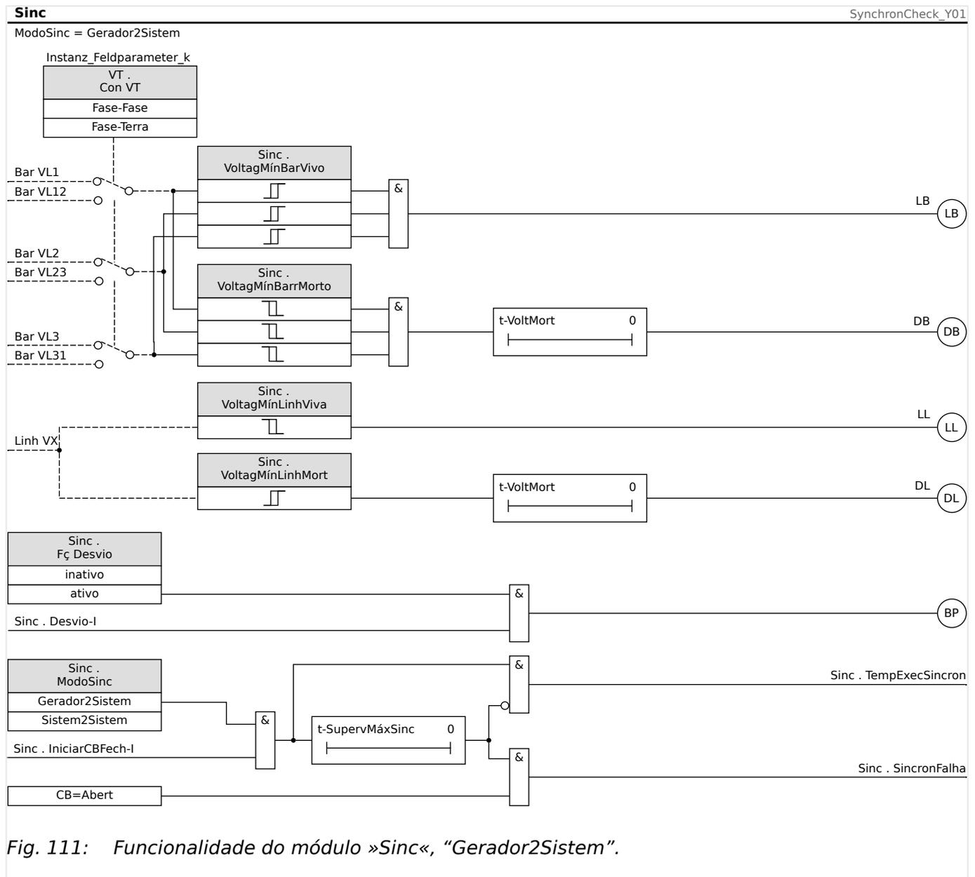
Fig. 111: Funcionalidade do módulo »Sinc«, “Gerador2Sistem”.
