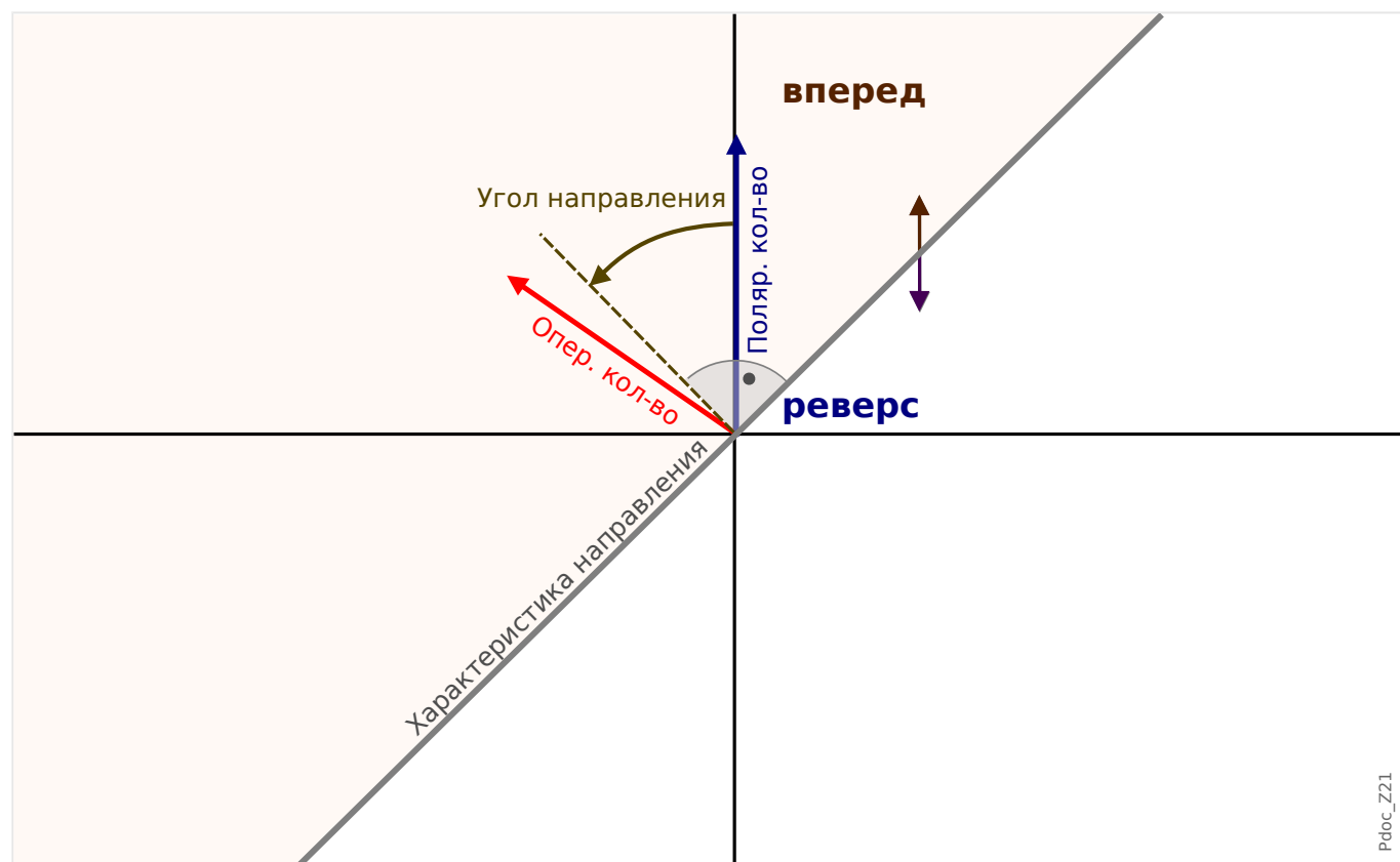
Рис. 62: Принцип определения направления межфазного короткого замыкания.
