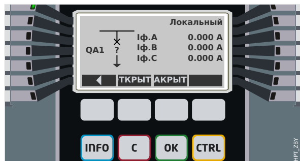
Рис. 65: Пример страницы управления, выключатель в аварийном (недопустимое состояние) положении.
