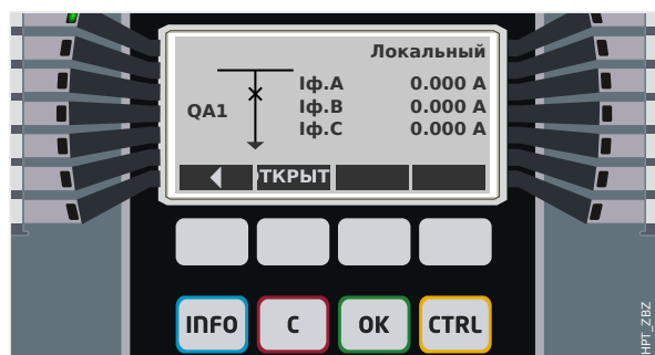
Рис. 64: Пример страницы управления, выключатель в замкнутом положении.
