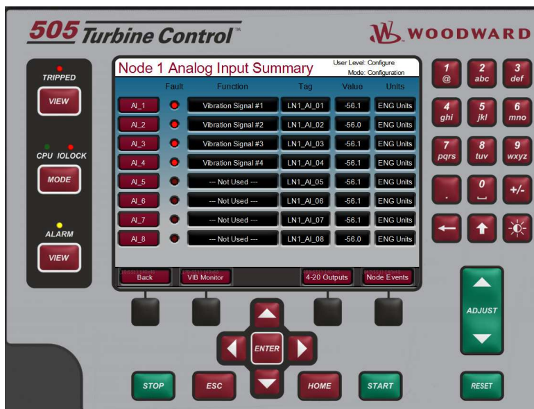
Rysunek 1-8. Moduł rozproszony LinkNet 1 ustawiony na 4 sygnały wibracji
