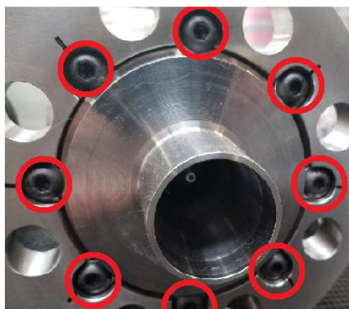
Рисунок 4–1. Изображение винтов подающего рукава
