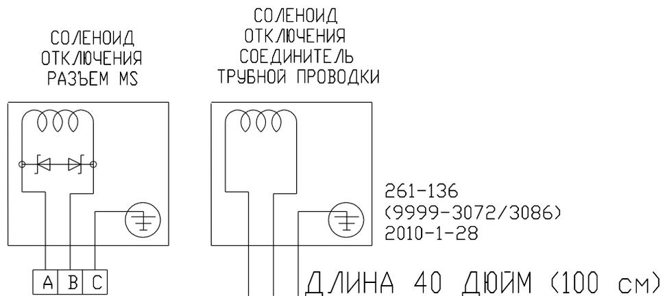
Рис. 1-11. Схематическое изображение электрической части электромагнитного клапана и схема электрических соединений
