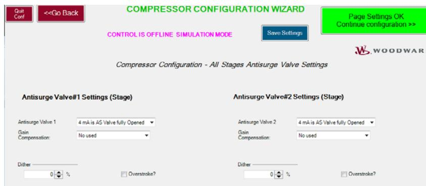
Рисунок 4-11. Настройки антипомпажного клапана
