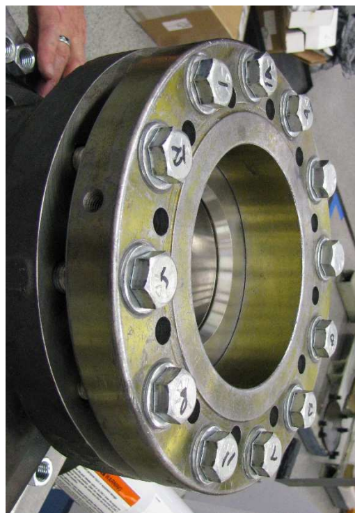
Рисунок 3–2. Приподнятые втулки с выступающим торцом
