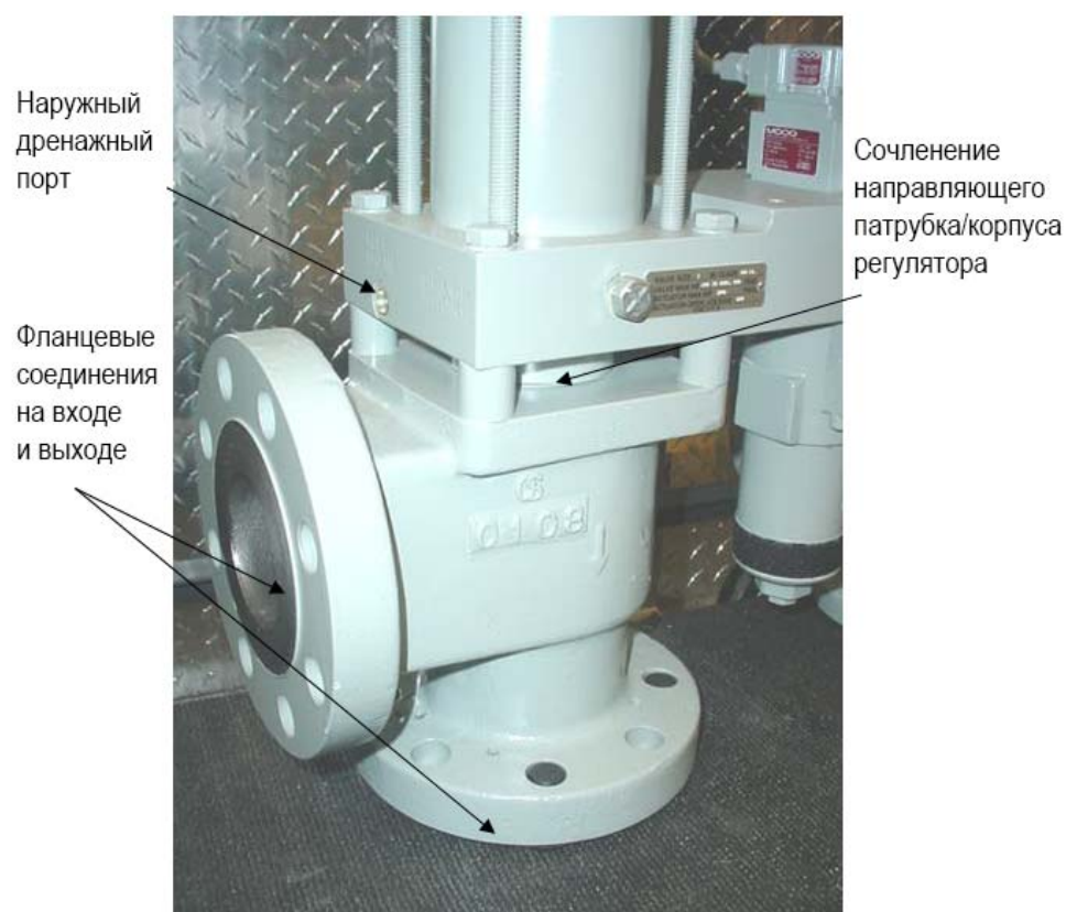
Рисунок 4–1а. Участки для проверки 2-дюймовых регуляторов
