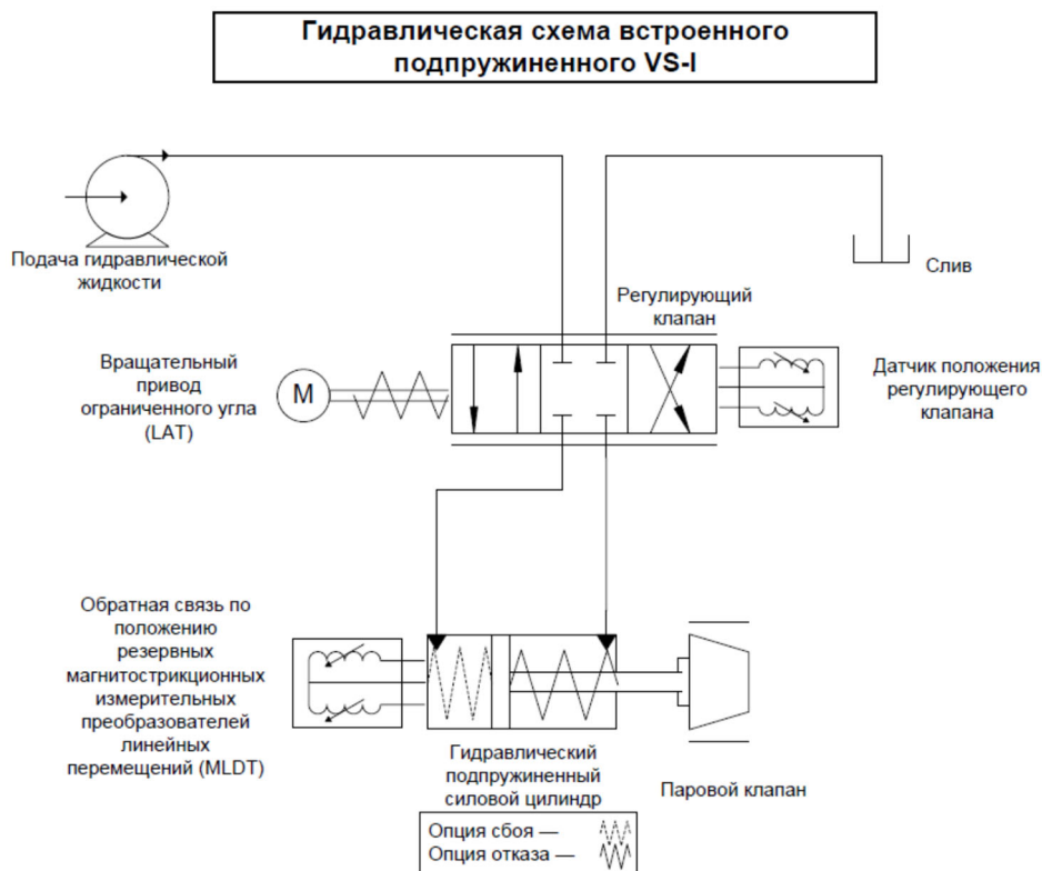
Рисунок 2–9. Гидравлическая схема встроенного подпружиненного VS-I
