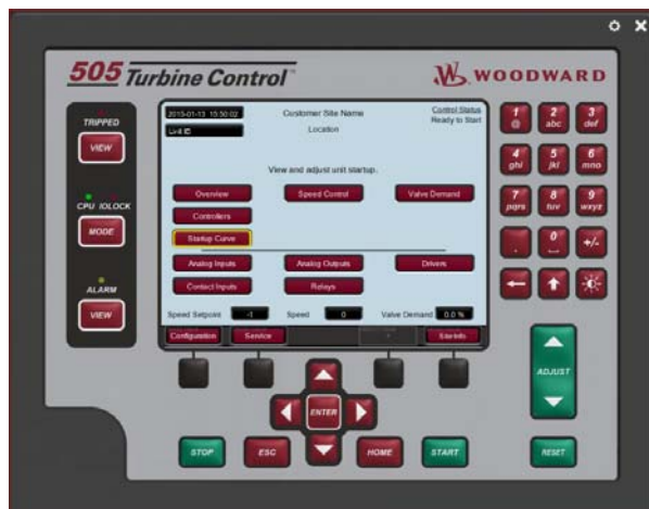
Рисунок 5-26. В меню HOME (ГЛАВНОЕ МЕНЮ) в фокусе отображается параметр Startup Curve (Кривая запуска)
