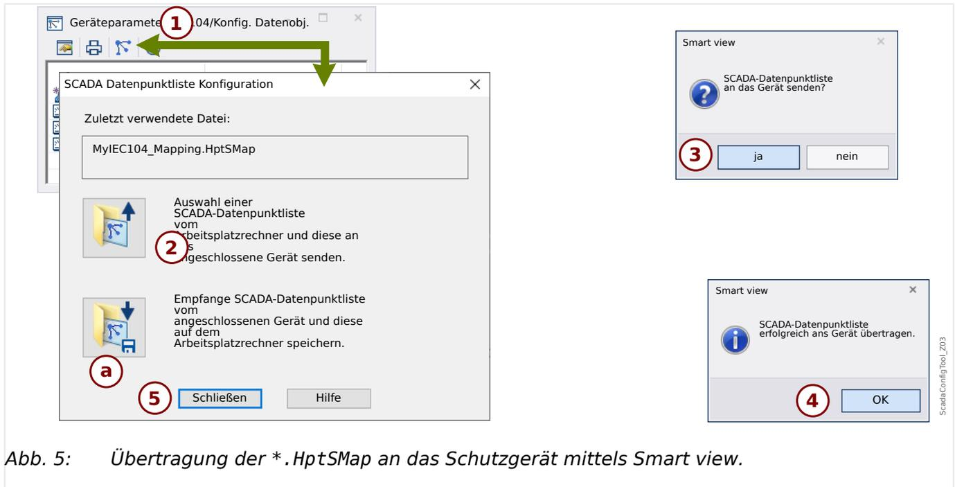
Abb. 5: Übertragung der \*.HptSMap an das Schutzgerät mittels Smart view.
