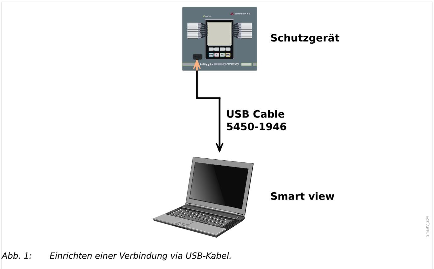
Abb. 1: Einrichten einer Verbindung via USB-Kabel.
