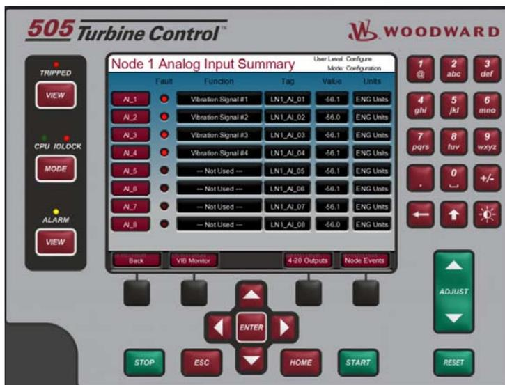
图 1-8.带有 4 个振动信号的 LinkNet 节点 1
