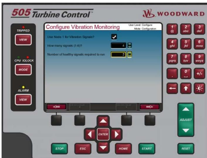
图 1-7.用于 LinkNet 节点 1 的振动向导
